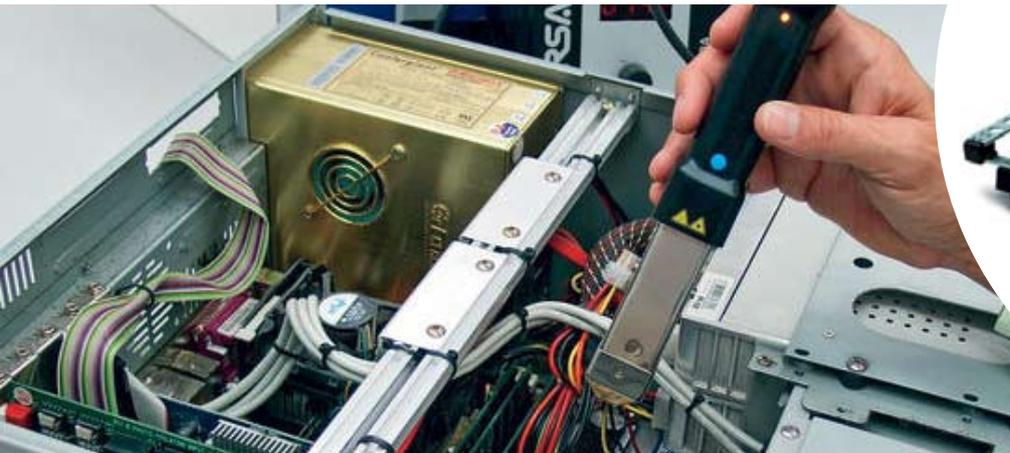
**Problemloses und sicheres Rework auf Platinen, die noch im Gehäuse eingebaut sind**
